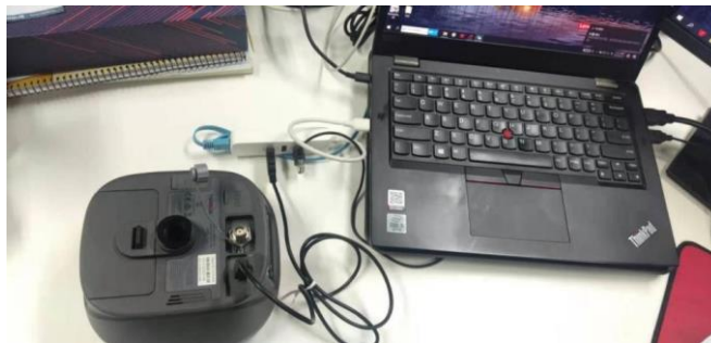
Изображение 8 Подключение кабеля Mini USB к приемнику и к компьютеру
