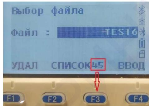
Для переключения между режимами ввода цифр или букв используйте клавишу [F3]. На дисплее отображается, в каком режиме в данный момент работает клавиатура (на фото – клавиатура работает в режиме ввода цифр).
