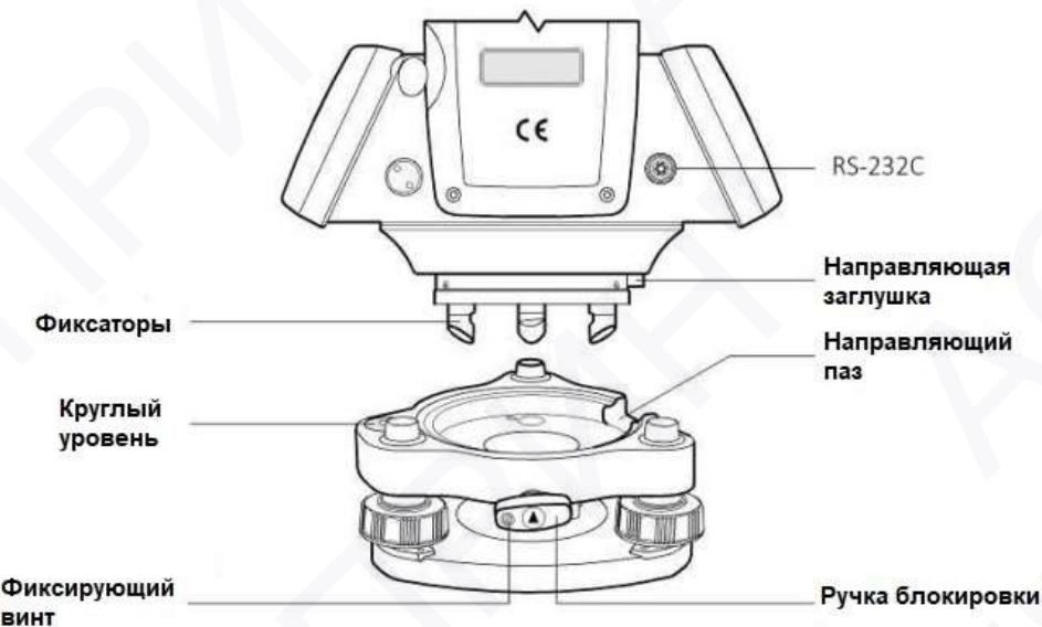
Для установки прибора в подставку вставьте три фиксатора в отверстия подставки и выровняйте направляющую заглушку с направляющим пазом. Поверните ручку блокировки примерно на 180° по часовой стрелке и затяните фиксирующий винт отверткой.
