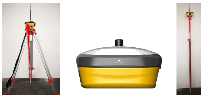
А: Наклонная высота Линия измерения В: Высота полюса
